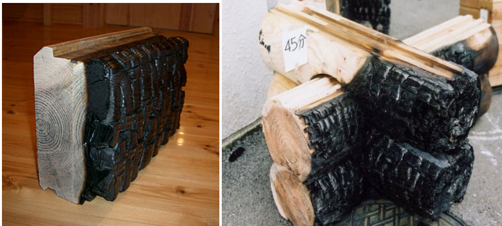
Links vierkant Blockbalken – Links Rundbalken nach ca. 45 Min Dauerbefeuerung
